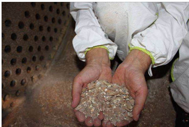
Foto 13 Geringe Menge von harten Ablagerungen am Boden der Zwischenkammer, die vom 1. Zug ausgeschieden werden.
