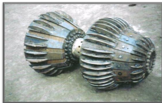
Hydrodynamiczny generator kawitacyjny HGK 700 dla średnicy rurociągu 700 mm.
