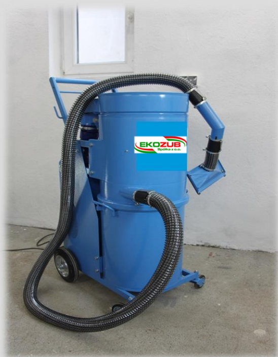
Poszczególne elementy wirowego odkurzacza przemysłowego
