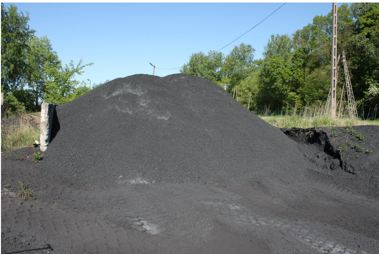
Fot. 1 Niezadaszone składowisko węgla narażone na wpływ warunków atmosferycznych.
