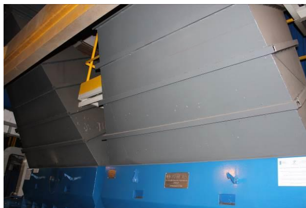
Fot. 7 Dolna część zasobnika węgla po roku pracy bez śladów uderzeń mechanicznych
