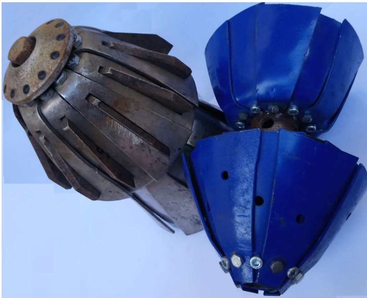
Fot. 1. Hydrodynamiczny generator strumieniowo-kawitacyjny
